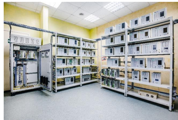
Испытательный полигон «ИНБРЭС» – цифровая модель ПС 500 кВ
